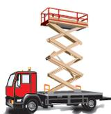
**2A-** La translation avec la plate-forme de travail en position haute ne peut être commandée que par un organe situé sur le châssis. Élévation verticale.
