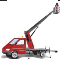
**1B-** La translation n'est admise qu'avec la plate-forme de travail en position de transport. Élévation multidirectionnelle.
