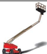
**3B-** La translation avec la plate-forme de travail en position haute ne peut être commandée que par un organe situé sur la plateforme de travail. Élévation multidirectionnelle.
