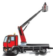
**2B-** La translation avec la plate-forme de travail en position haute ne peut être commandée que par un organe situé sur le châssis. Élévation multidirectionnelle.
